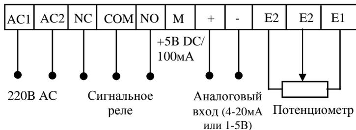
AC1 и AC2 – терминалы для подключения вспомогательного напряжения 220В 50Гц.
