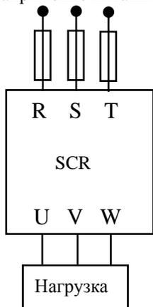
Назначение терминалов и схемы подключения.
